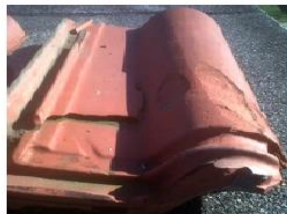
Degradação por ação do gelo.
