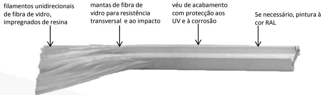
A fibra de vidro, nome comum dos PRFV (Polímeros Reforçados com Fibra de Vidro), é um material compósito com excelentes propriedades isolantes, com elevada resistência mecânica, química e às altas temperaturas.
