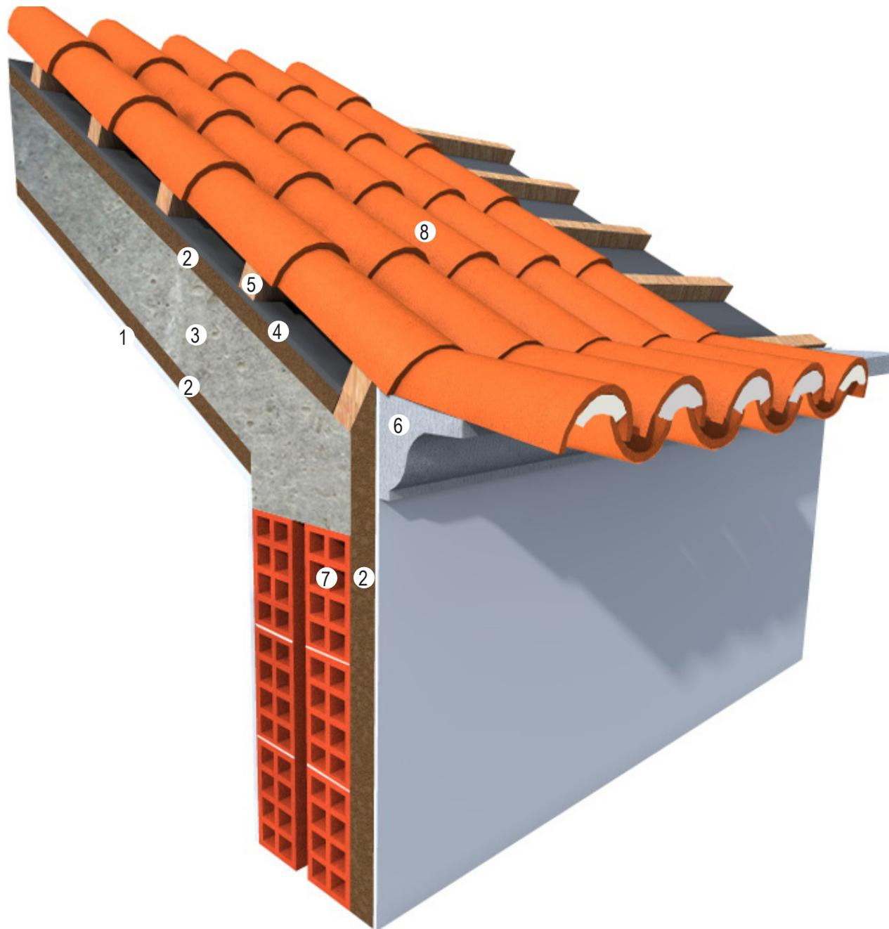
Quando a cobertura inclinada é habitada instala-se o isolamento imediatamente a seguir ao suporte das telhas, haverá casos em que pode ser interessante instalar outra camada de isolamento pelo lado inferior da laje de betão.
